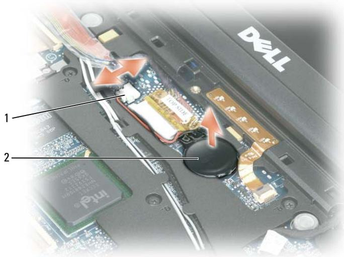
1 conector do cabo    2 bateria de célula tipo moeda
