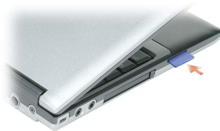
Para remover uma placa Secure Digital, pressione a placa e ela saltará para fora. Retire a placa do computador.
